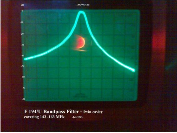
Il mio filtro - Regolazione a 144.300 MHz sotto network Analyzer HP141T
