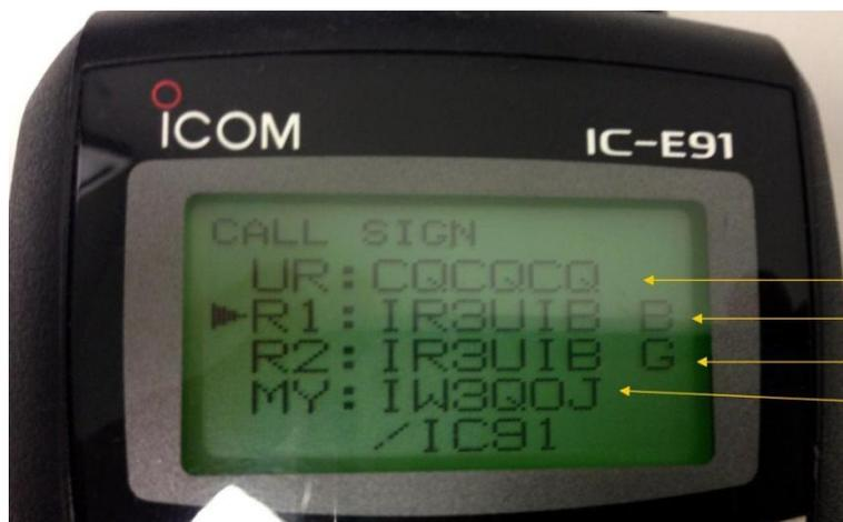
**Quello che occorre configurare attraverso il menù di un apparato radio DSTAR (in rosso)**
